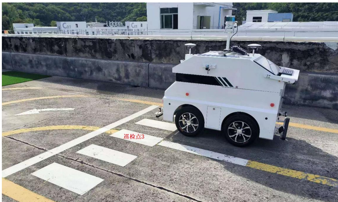
在红绿灯检测区域内，检测到红灯时车辆停车，绿灯时车辆行驶
